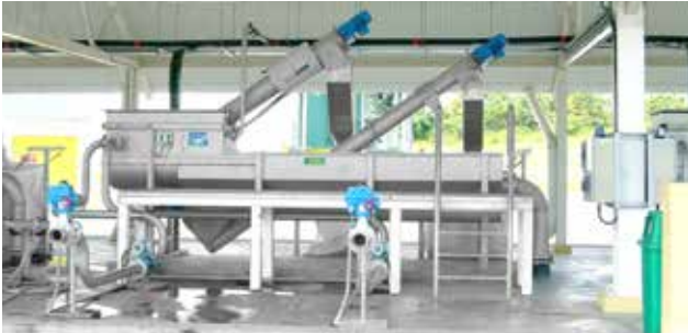
HUBER Fäkalannahmestation ROTAMAT® Ro3.3 mit unbelüftetem Sandfang und integrierter Sandklassierschnecke.
