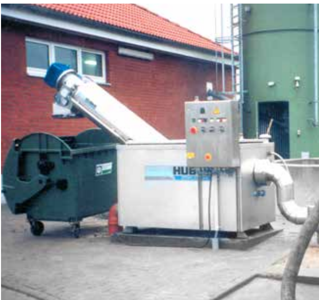
HUBER Fäkalannahmestation ROTAMAT® Ro3.1 mit HUBER Feinstrechen ROTAMAT® Ro1 in beheizter und isolierter Ausführung.
