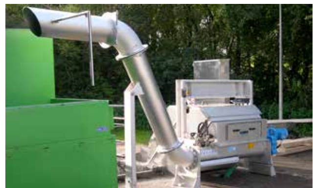
Zuverlässig Rechengut behandeln mit der HUBER Waschpresse WAP®.
