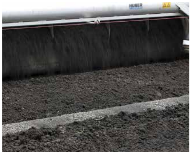
Der HUBER Schlammwender SOLSTICE® sorgt für ein optimales Trocknungsbeet – der Schlamm wird ausgebreitet, granuliert, belüftet, gewendet und rückgemischt.
