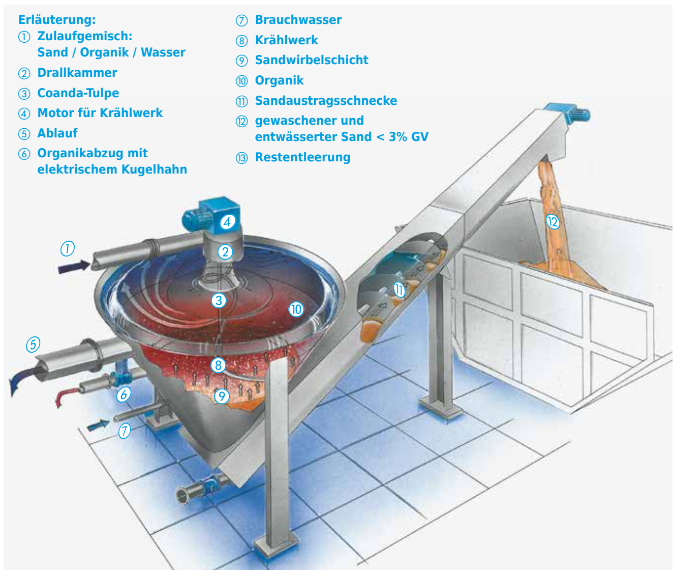
Prinzipische Skizze der HUBER Coanda Sandwaschanlage RoSF4.
