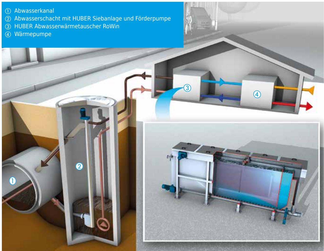
Entnahme von Energie aus Abwasser mit dem HUBER ThermWin-Verfahren.
