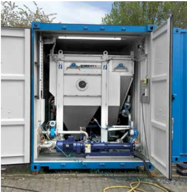
HUBER Anlagentechnik in Containerbauweise – Flotationen oder Schlammwässerungen ohne Bauarbeiten – sofort einsatzbereit.
