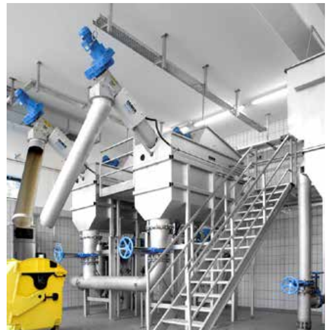
HUBER Siebanlage ROTAMAT® Ro2 mit Hochdruckreinigung – beste Reinigungsergebnisse und angepasste Maschinenteknik.
