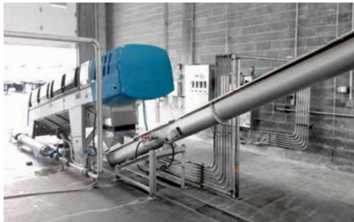
HUBER Schneckenpressen zur Schlammbehandlung – beste Entwässerungsleistung und höchste Volumenreduktion zur Senkung der Entsorgungskosten.
