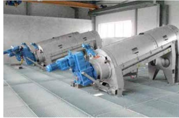
HUBER Schneckenpressen zur Schlammbehandlung – beste Entwässerungsleistung und höchste Volumenreduktion zur Senkung der Entsorgungskosten.
