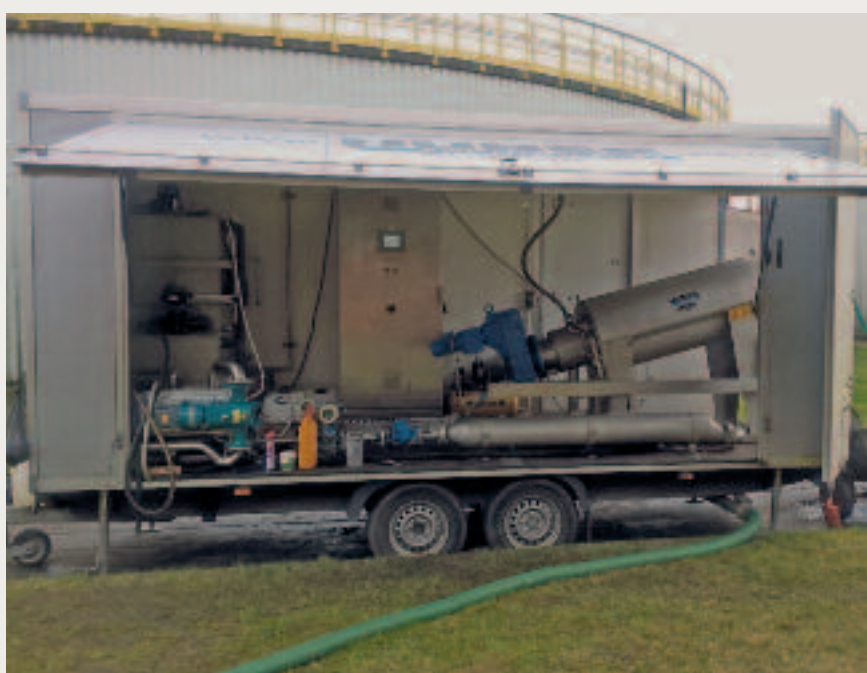
Mobile Ausführung der HUBER Schneckenpresse Q-PRESS® für Testzwecke
