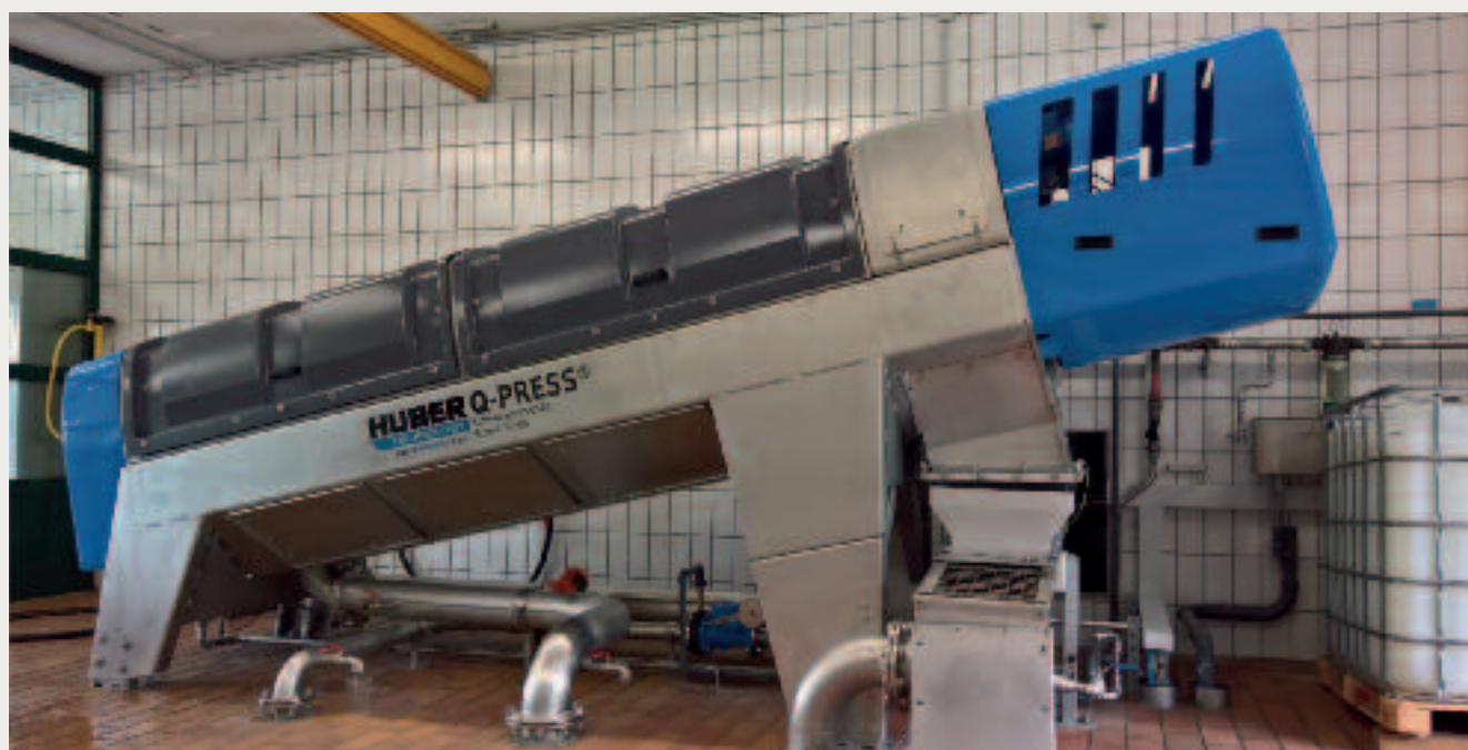
Q-PRESS® 620.2 für einen Durchsatz von 200 kg TR/h
