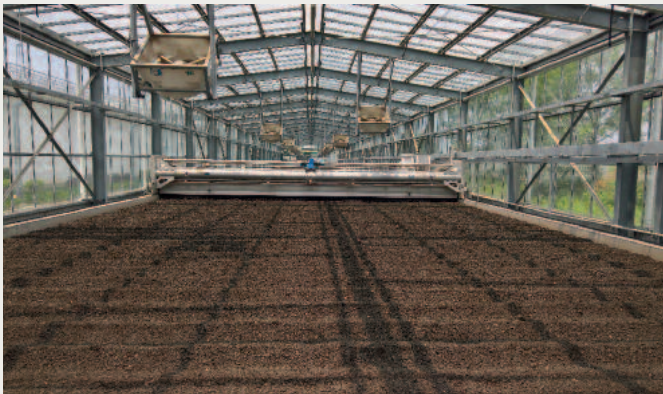
Abbildung 1: Der HUBER Schlammwender SOLSTICE® ist das Herzstück der solaren Schlamm-trocknung. In Kombination mit der intelligenten HUBER Klimasteuerung sorgt er für eine effiziente und betriebssichere Schlamm-trocknung
