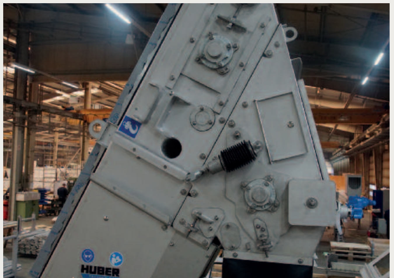
Lochblech-Umlaufrechen EscaMax® mit selbst einstellendem Bürstensystem zur Reduzierung des Wartungsaufwandes und zur Verschleißminimierung
