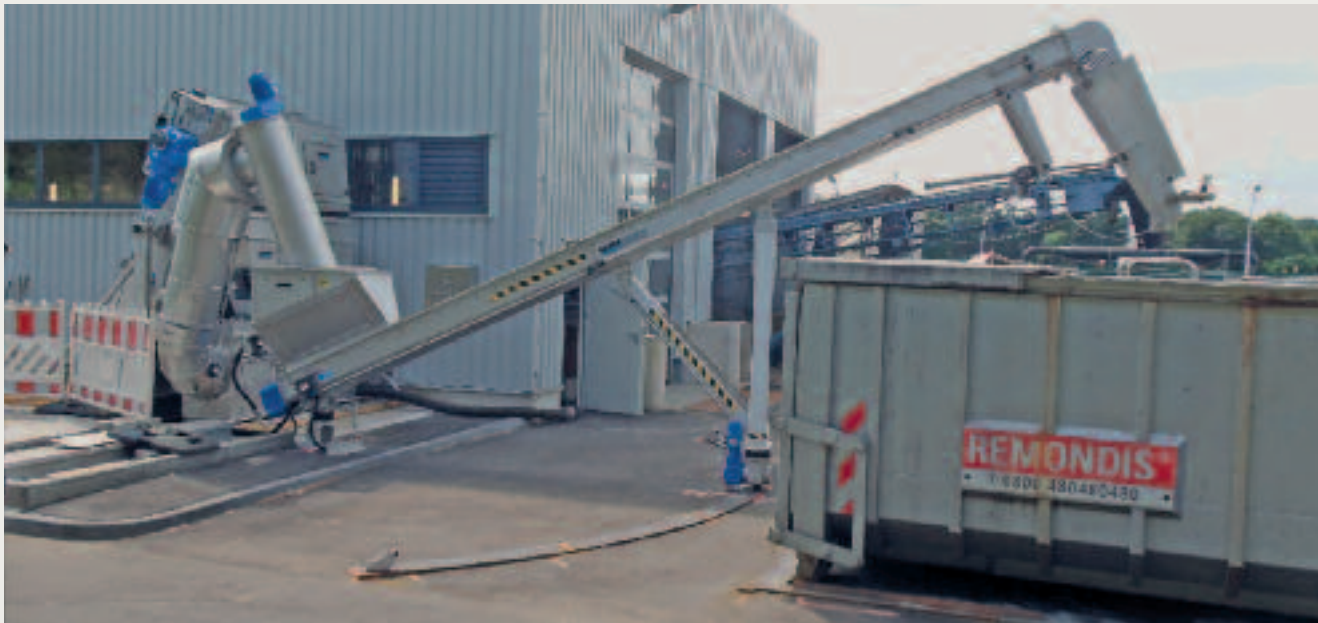
Die gesamte Anlage bestehend aus HUBER Harken-Umlaufrechen RakeMax®, HUBER Waschpresse WAP® mit Rechengutzerkleinerer sowie schwenkbarer HUBER Trogförderschnecke Ro8 T
