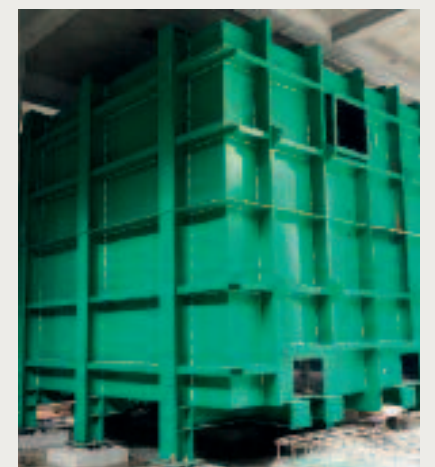
Abbildung 1: Schlammbehälter für das Projekt Bello
