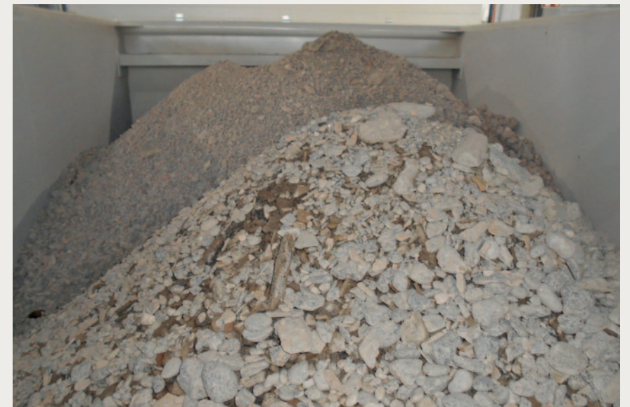
Ausgewaschene Grobstofffraktion mit einem geringen Anteil an Organik nach dem HUBER Grobstoffwäscher RoSF13
