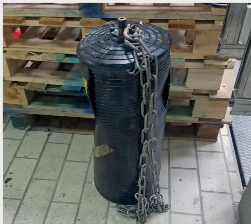
Die Störstofferkennung Safety Vision erkannte ein Rohrdichtkissen vom Kanalbau und vermied effektiv eine Beschädigung der Anlage
