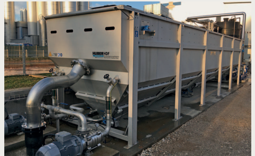
HDF S8 mit redundanter Recyclestromaufbereitung für maximale Betriebssicherheit
