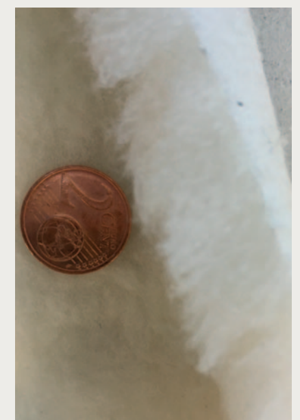
Querschnitt eines Polstoff-Filtergewebes, wie es im HUBER Scheibenfilter RotaFilt® zum Einsatz kommt
