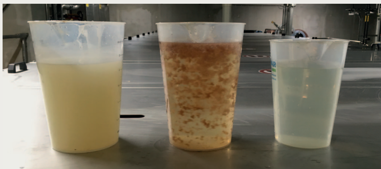
Im Vergleich: Zulauf - chemische Stufe - Ablauf. Ein beeindruckendes Ergebnis
