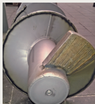
Neuzustand - Ansicht der Stirnfläche einer Waschpressen Schnecke mit aufgeschweißten letzten Wendelviertel für den Verschleißschutz
