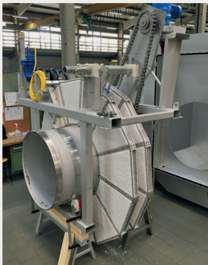
HUBER Scheibenfilter RotaFilt® mit zwei Filterscheiben
