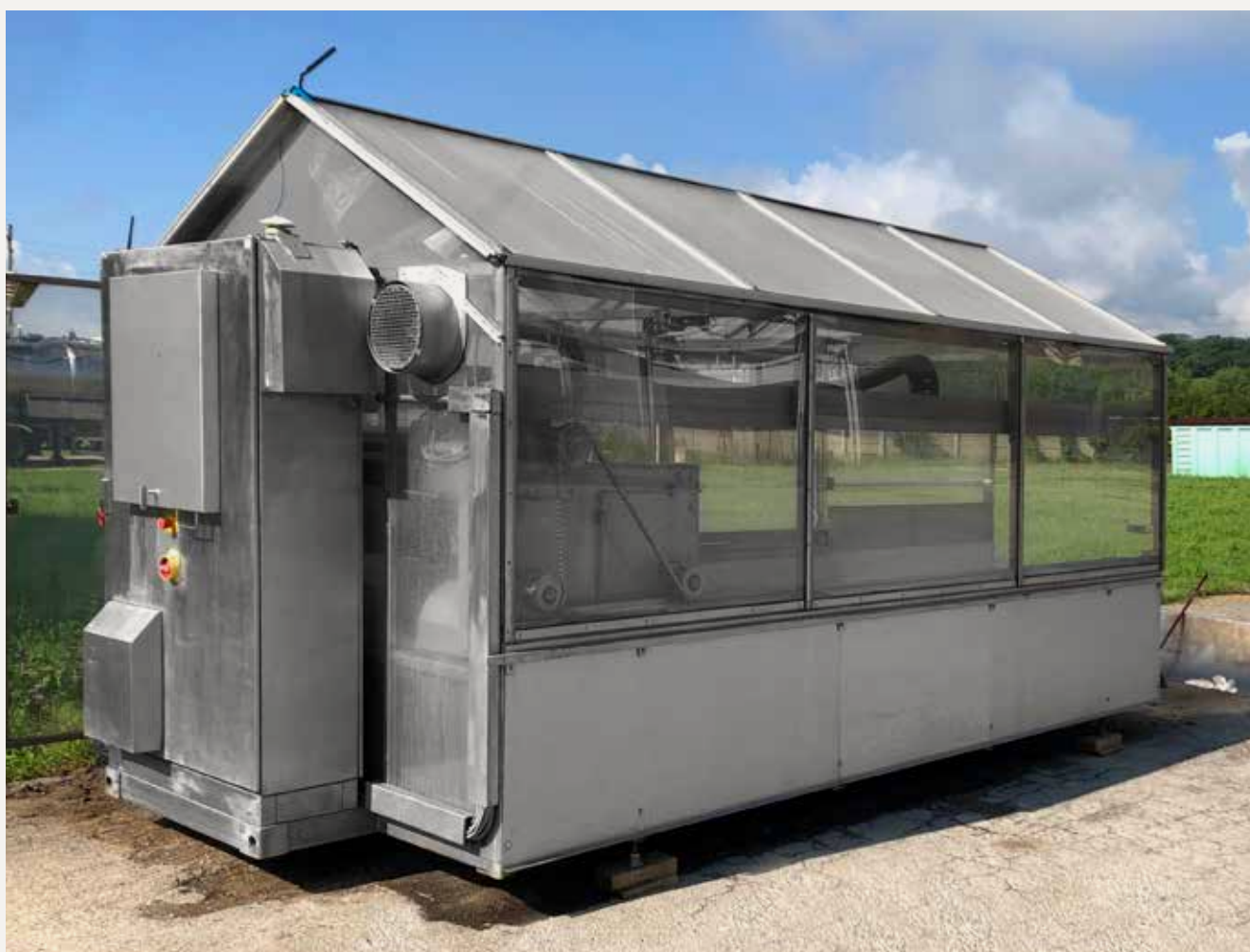
„Baby SOLSTICE®“: HUBER Schlammwender SOLSTICE® Versuchstrockner in der Aufbauphase beim Kunden vor Ort.
