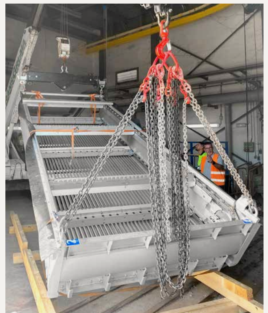
HUBER Technology España lieferte 3 HUBER Harken-Umlaufrechen RakeMax® für den Partidor de Arroyofresno.
