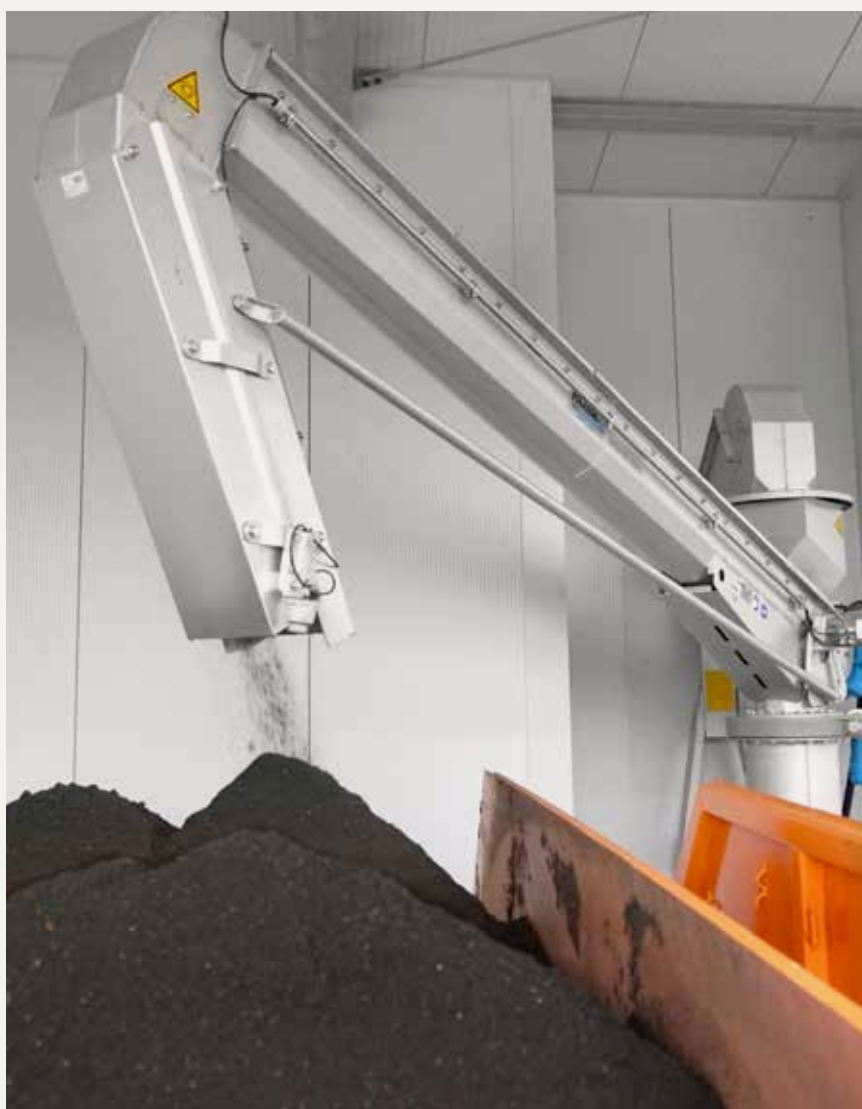
HUBER Trogförderschnecke Ro8 TC mit Höhenstandmessung und motorischer Positionsverstellung.
