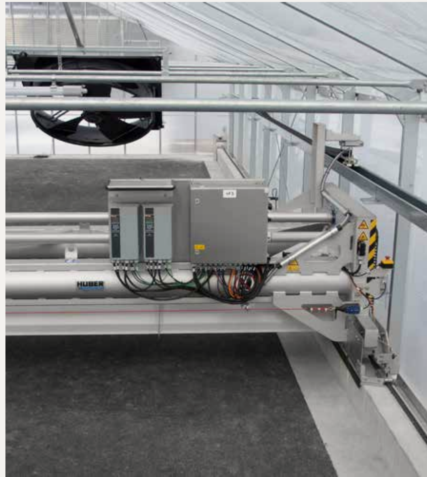
Im linken Bild ist der neu entwickelte HUBER Schlammwender FloorRunner® zu sehen, der direkt auf dem Boden fährt. Rechts der HUBER Schlammwender SOLSTICE®, der auf einer betonierten Fahrbahnmauer fährt.
