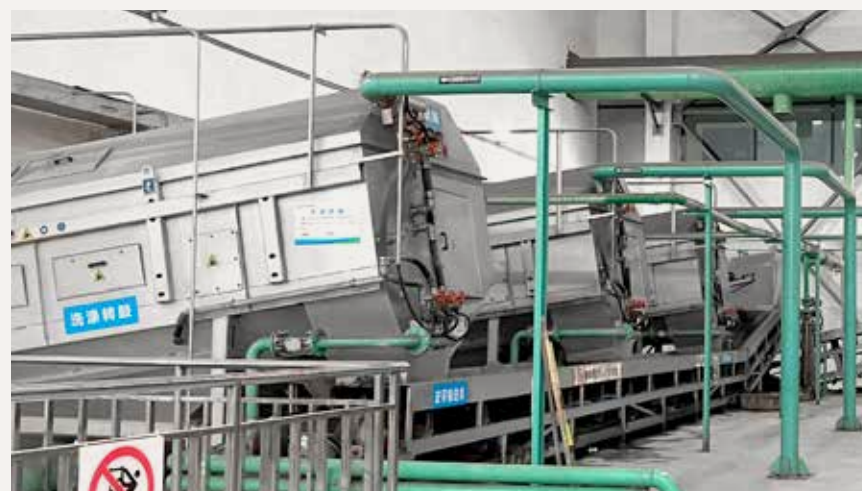
Die HUBER Sandaufbereitungsanlage in Wuhan ist eine der größten weltweit.
