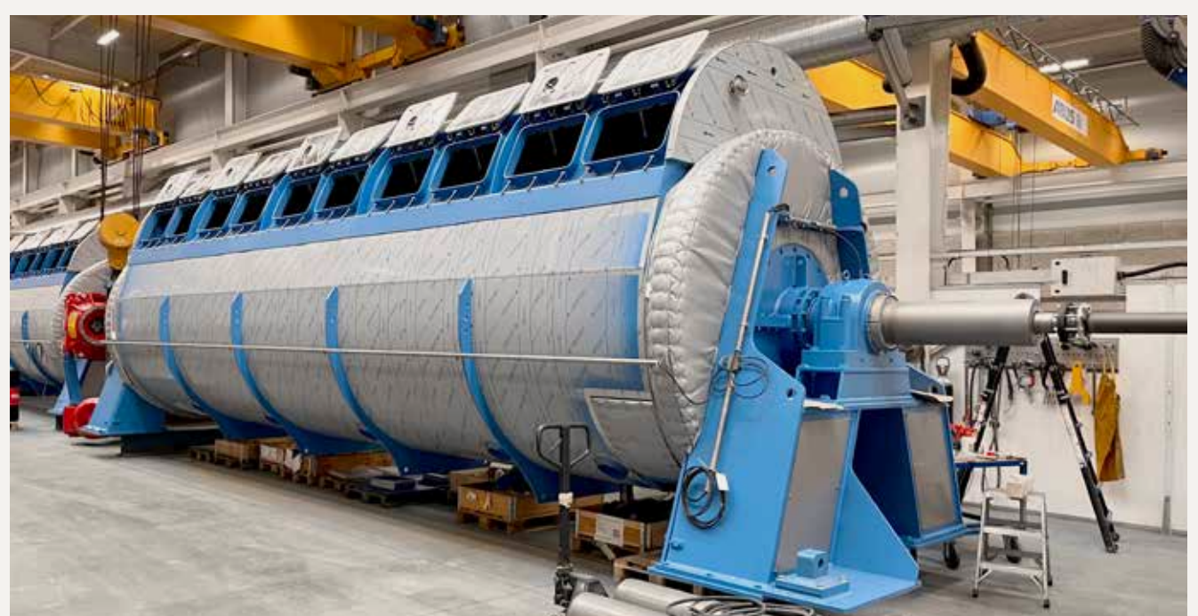
3 HUBER Scheibentrockner RotaDry® für VERA II, Deutschlands größte Anlage zur Verwertung von Klärschlamm.
