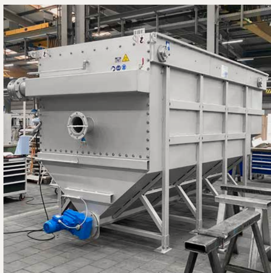
Einer der HUBER Abwasserwärmetauscher RoWin in der Fertigung der HUBER SE am Unternehmenssitz Berching.
