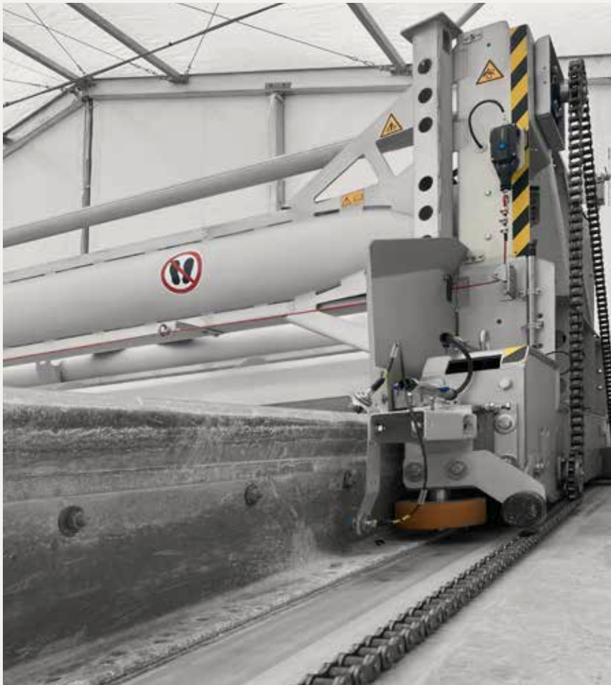
Im linken Bild ist der neu entwickelte HUBER Schlammwender FloorRunner® zu sehen, der direkt auf dem Boden fährt. Rechts der HUBER Schlammwender SOLSTICE®, der auf einer betonierten Fahrbahnmauer fährt.
